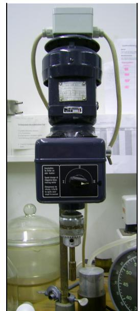
Abb. 8 Antriebseinheit des Micromixers
