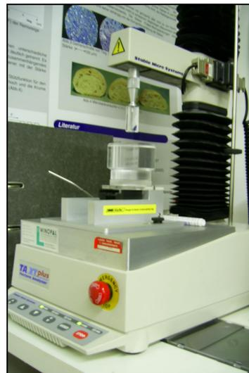
**Abb. 12** Texture Analyser mit Stempel zur Krumenmessung
