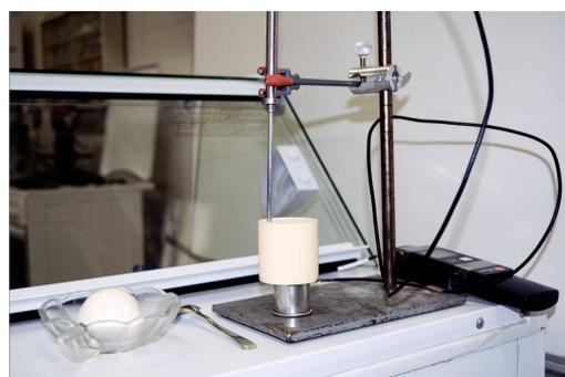
Abbildung 6: Meßgerät für den Schmelzversuch
