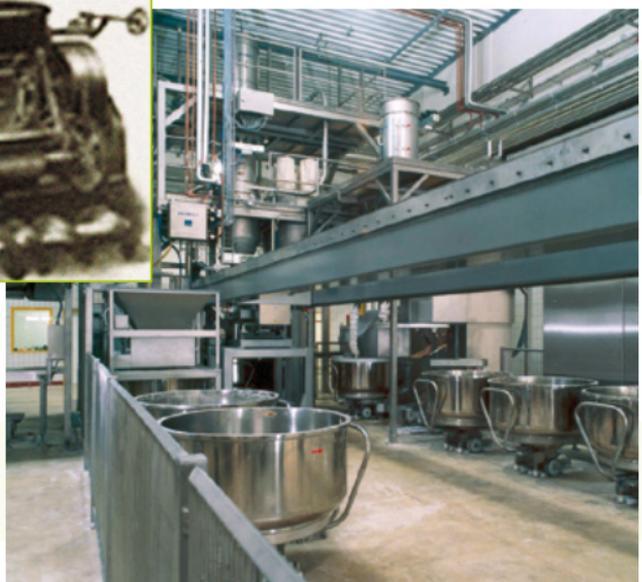
Vollautomatische Knetanlage von Diosna 2015
